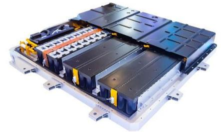
Die 100%ige Endprüfung von Batteriesystemen und deren Kühlkreisläufen wird in der Regel als Differenzdruckprüfung mit Vakuum oder Druckluft von - 900 mbar bis 4 bar rel. und in seltenen Fällen bis 6 bar rel. durchgeführt. Diese Tests werden während der Produktion, aber auch in regelmäßigen Abständen an den Servicestationen durchgeführt.
